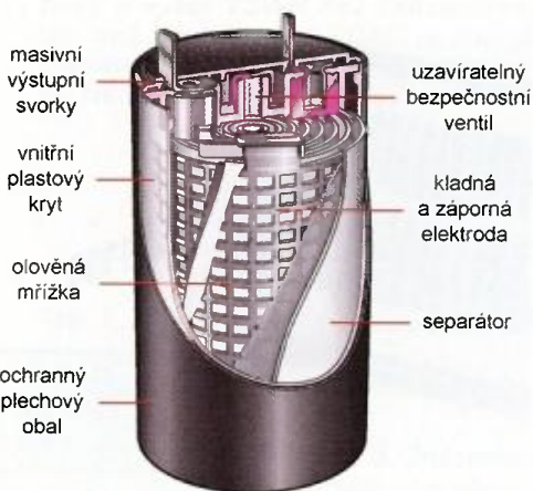
Obr. 1. Konstrukce článku Cyclon
