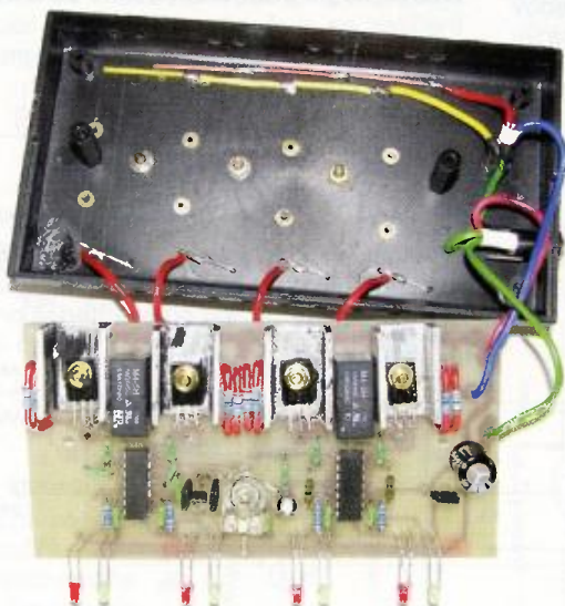
Obr. 4 a 5. Fotografie mechanického uspořádání nabíječky
