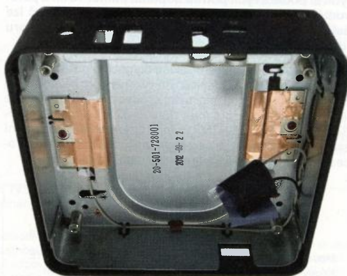
Prázdná skříňka počítače s připravenými anténami
