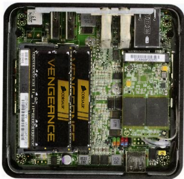
Pohled na základní desku v otevřeném počítači
