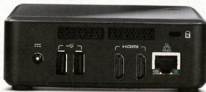
Pohled na zadní stranu počítače se dvěma výstupy HDMI
