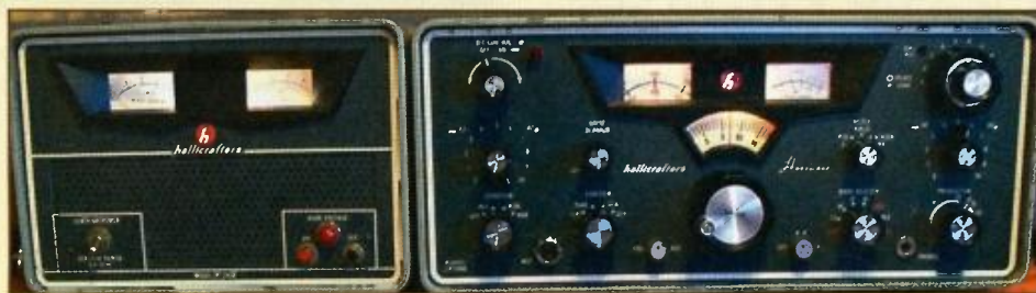
Obr. 68. Transceiver SR-2000 Hurricane, vlevo napájecí zdroj
