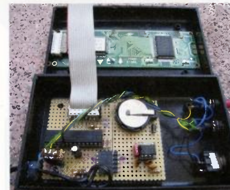
Obr. 10 a 11. Prístroj na sledovanie výpadkov napätia
