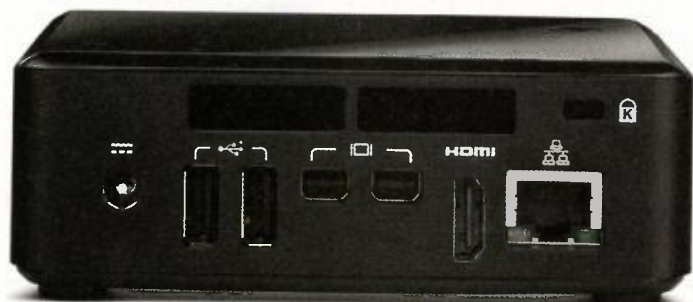
Pohled na zadní stranu počítače se dvěma Display Porty
