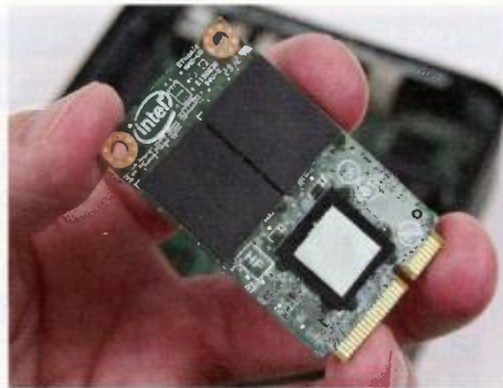
Polovodičový disk mSATA SSD
